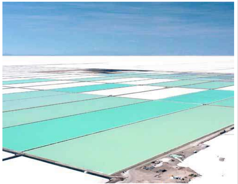
Proceso de evaporación de salmuera para la explotación de litio. AFP
